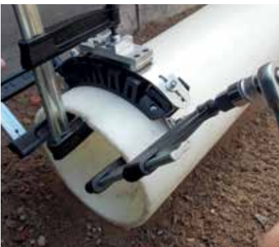
Przygotowanie przy zastosowaniu urządzenia dociskowego FIXBLOC FWFB
